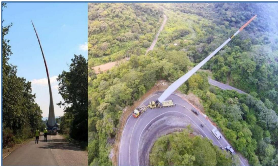
Fig. 5 -Esempi di Blade Lifter Trailer
