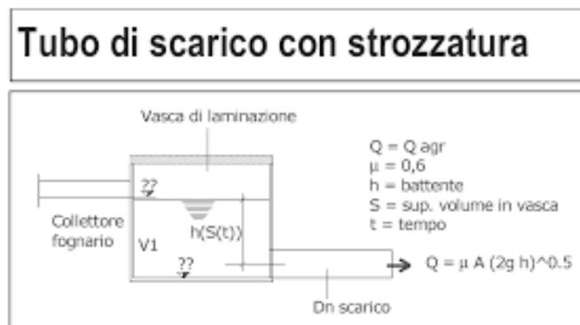
Considerando che la vasca di laminazione prevista avrà dimensioni 20 m X 5 m ed una altezza di 1 m ed una capacità di 100 m<sup>3</sup>, a vantaggio di sicurezza essendo superiore a valore calcolato di 50 m<sup>3</sup>, adottando un battente di 0,7 m e una tubazione in PVC DN140 per la strozzatura in uscita dalla vasca di laminazione, si ottiene una portata massima di 29,15 l/s, leggermente inferiore a quella massima ammissibile pari a 30 l/s.
