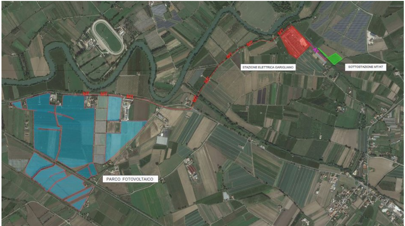
Ortofoto con indicazione del Parco Fotovoltaico e del cavidotto di connessione alla Sottostazione Elettrica di Utente (SSE) di proprietà del Produttore
