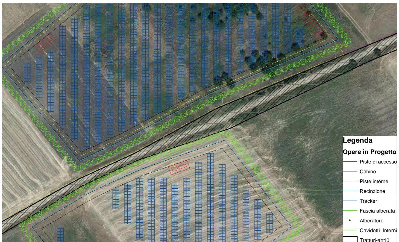
Figure 5.11. – Cavidotto e Tratturo Tolve Gravina
