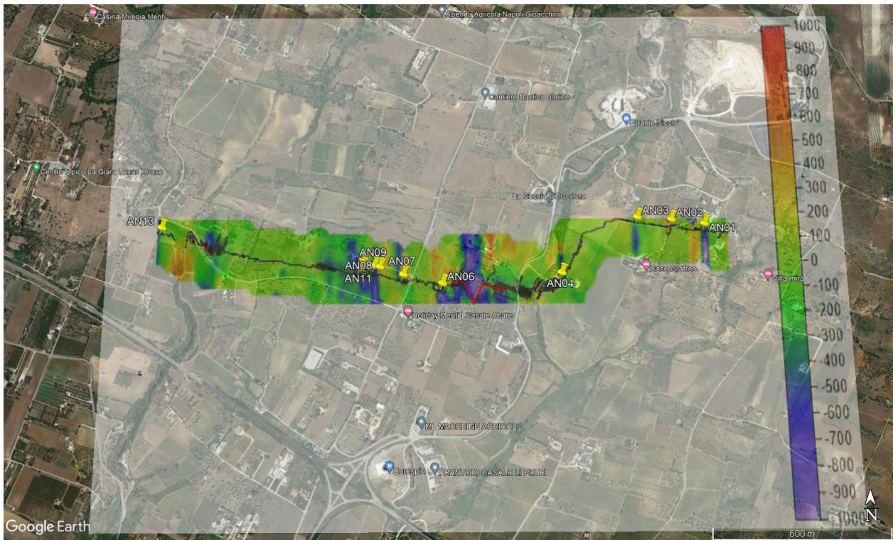
Fig.2 – overlay su supporto ortofoto Google earth Mappa di gradiente magnetico range +/- 1000 nT/m con evidenza del tracciato eseguito e relative anomalie
