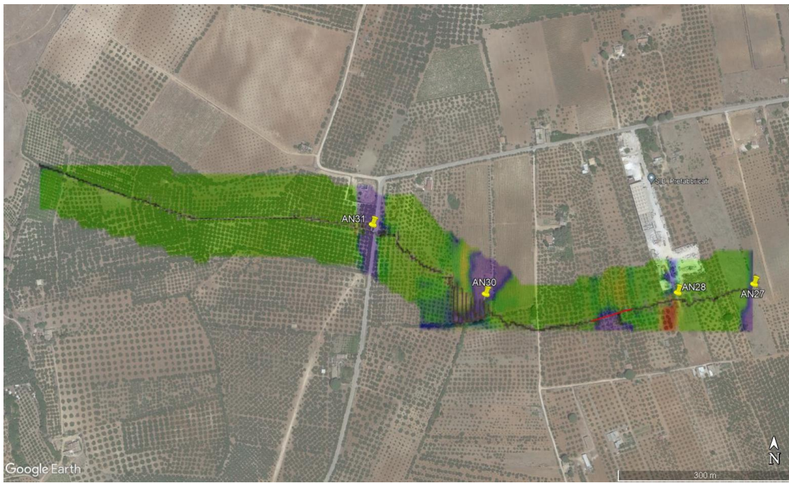
Fig.10 – overlay su supporto ortofoto Google earth Mappa di gradiente magnetico range +/- 1000 nT/m con evidenza del tracciato eseguito e relative anomalie
