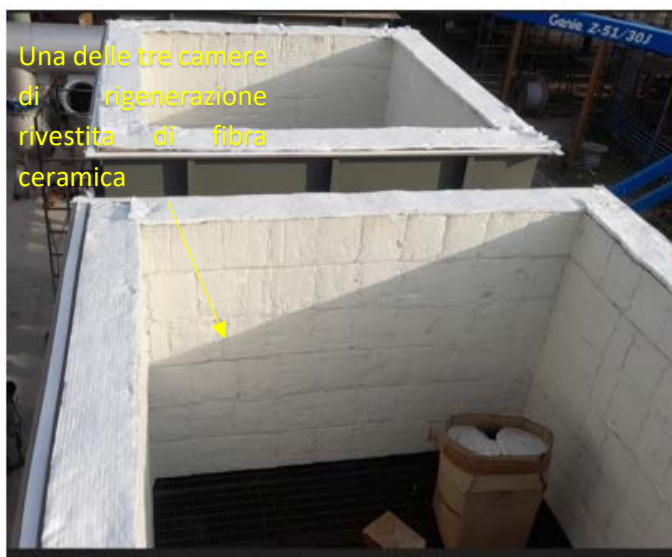
Figura 9 Camere e mattoni ceramici a nido d'ape di un RTO
