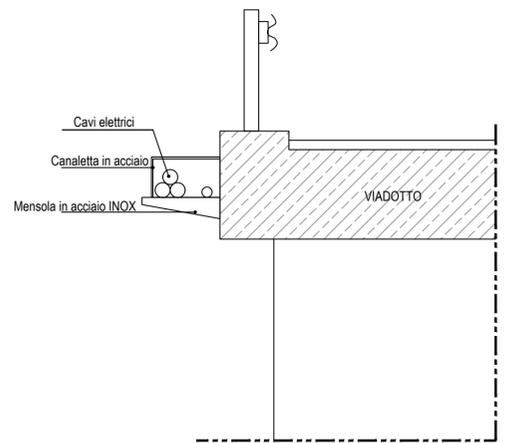
**ATTRAVERSAMENTI MEDIANTE CANALETTA PORTA CAVI SU VIADOTTO**
