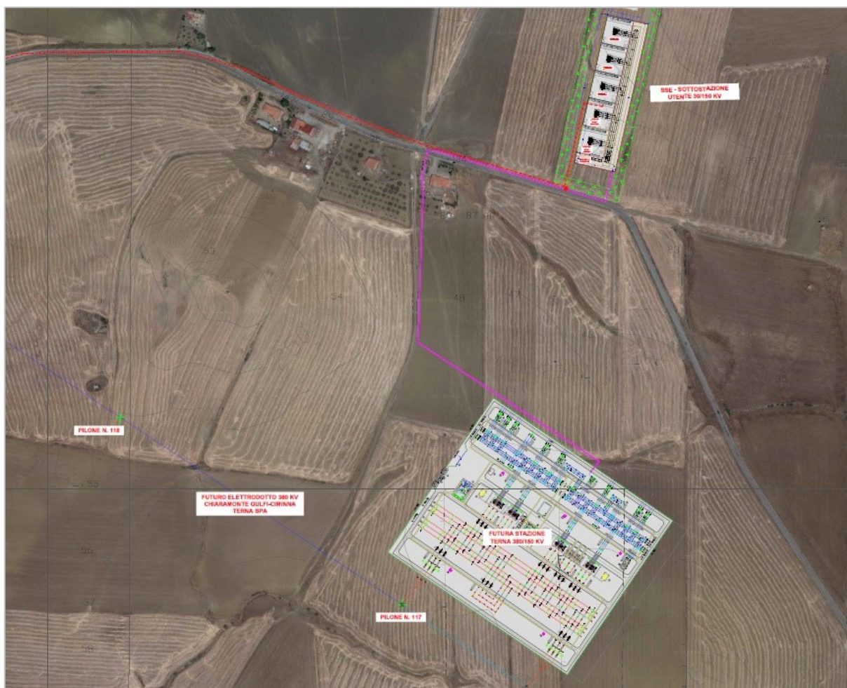
Planimetria generale della SSE e delle opere di connessione alla RTN su Ortofoto (FR-RADDUSA-AFV-PD-D-5.1.3.0-r0A-R00)
