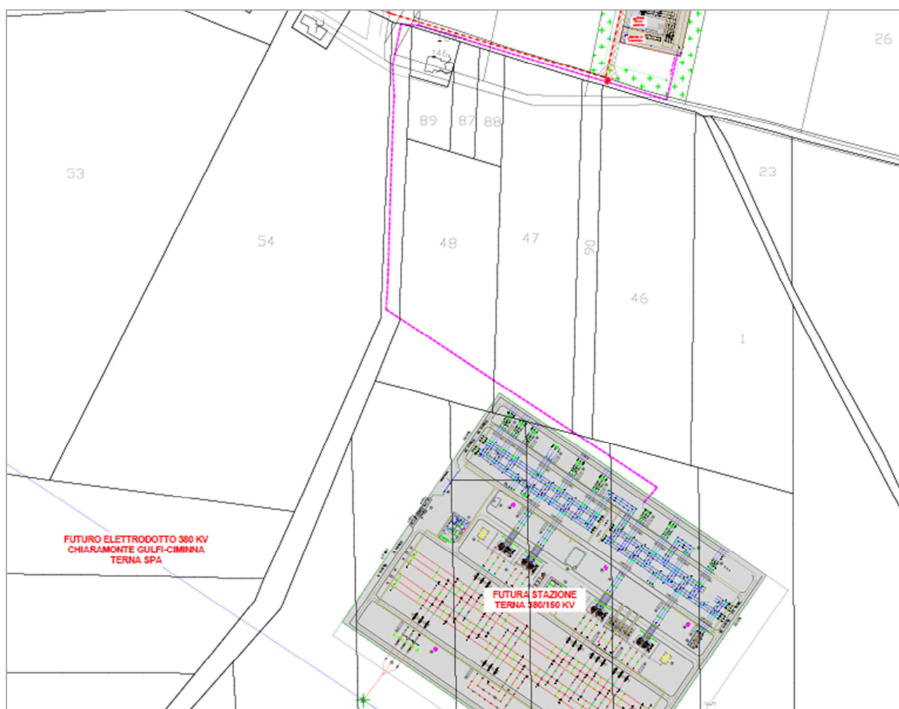
Tracciato elettrodotto AT interrato su planimetria catastale
