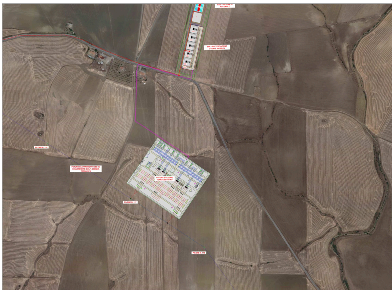
Planimetria generale della SSE e delle opere di connessione alla RTN su Ortofoto (FR-RADDUSA-AFV-PD-D-5.1.3.0-r0A-R00)
