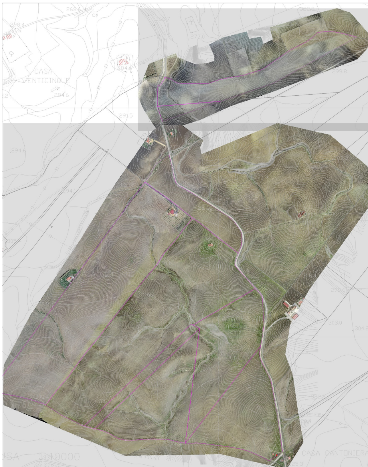
Rilievo aerofotogrammetrico dell'area del campo agrivoltaico eseguito con Drone
