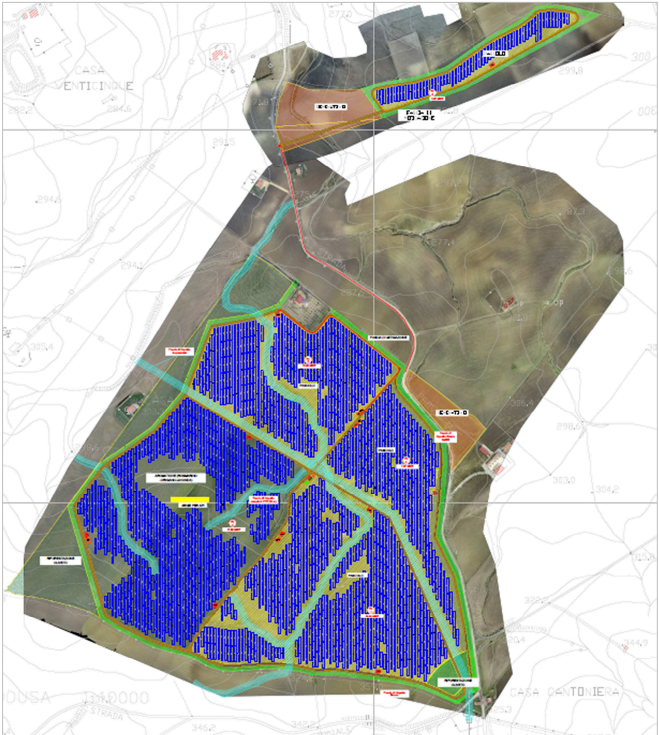
Lay-out generale dell'impianto agrivoltaico (FR-RADDUSA-AFV-PD-D-1.6.0.0-r0A-R00)
