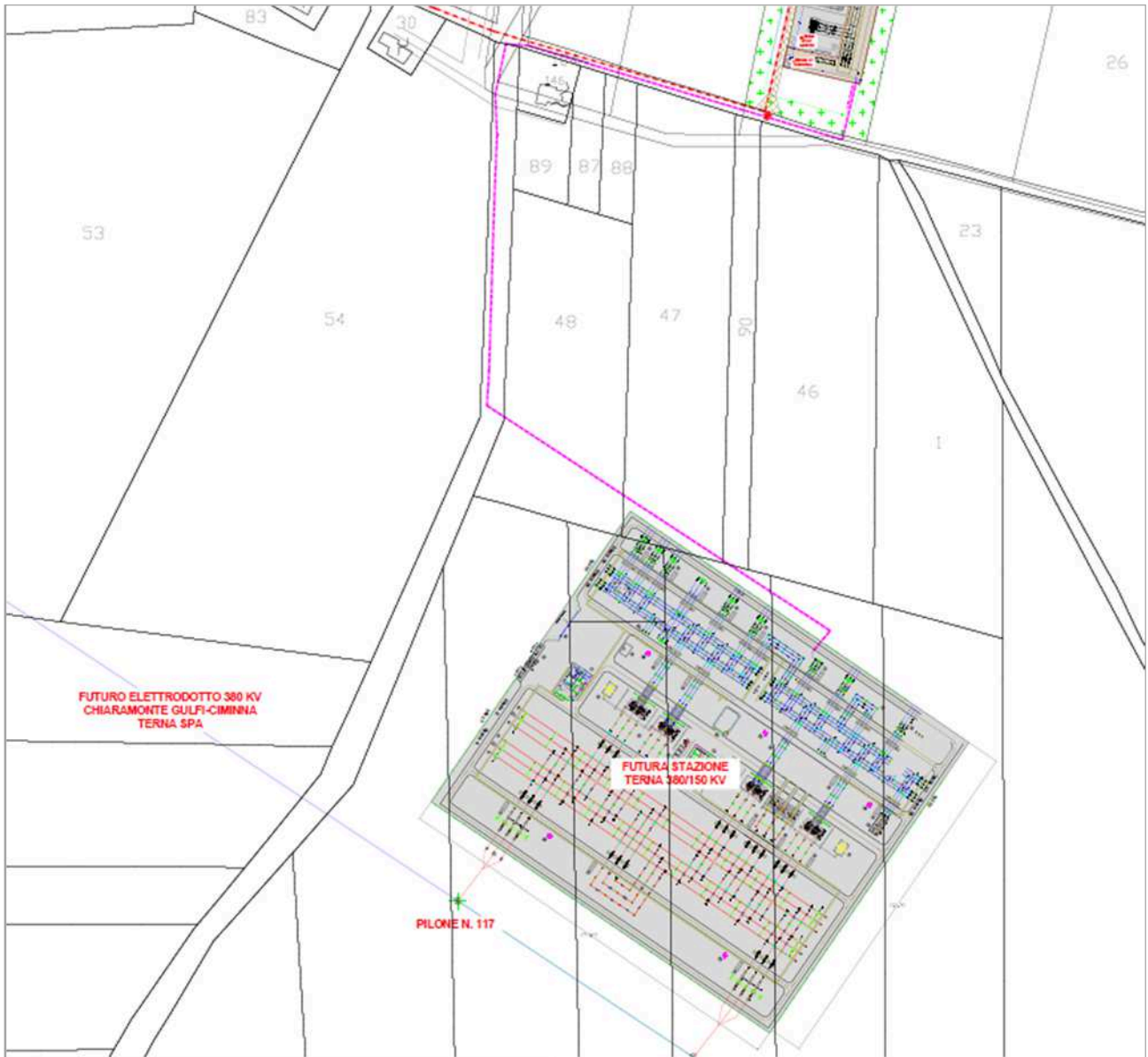
Tracciato elettrodotto AT interrato su planimetria catastale
