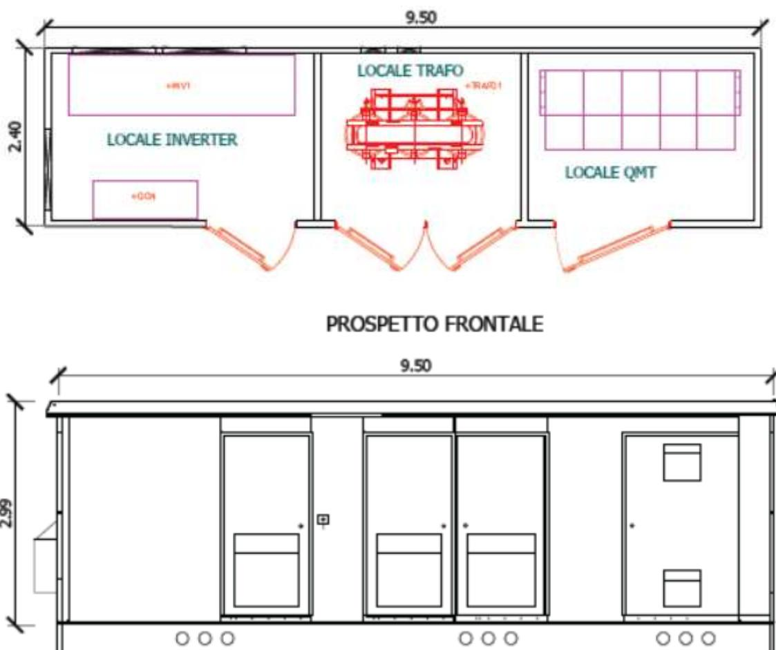
Figure 1: *Pianta e prospetto cabina power station tipo1*
