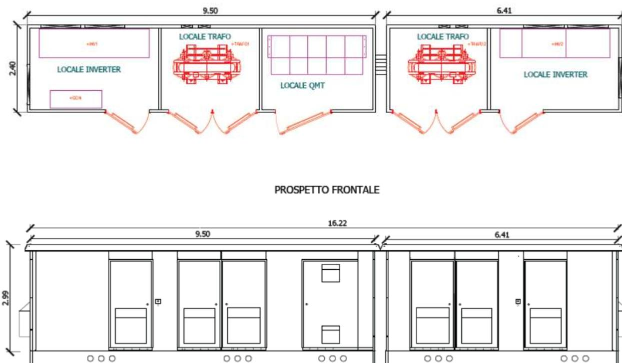
Figure 1: *Pianta e prospetto cabina power station tipo2*
