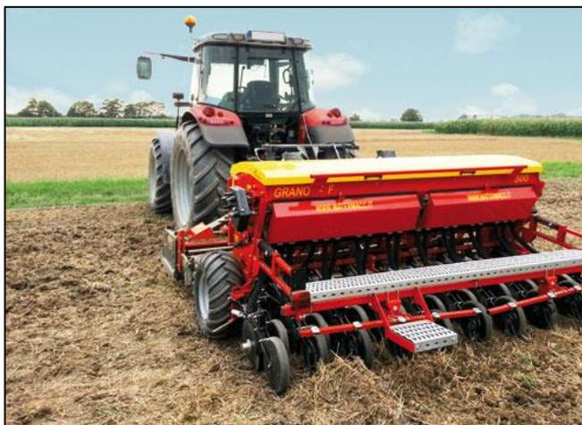
Figura 39: Esempio di seminatrice di precisione per tutte le tipologie di sementi
