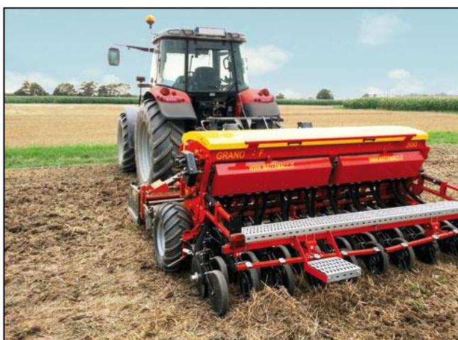
Figura 12: Esempio di seminatrice di precisione per tutte le tipologie di sementi
