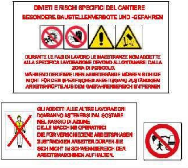
Figura 14: Segnaletica di cantiere in presenza di divieti e rischi specifici
