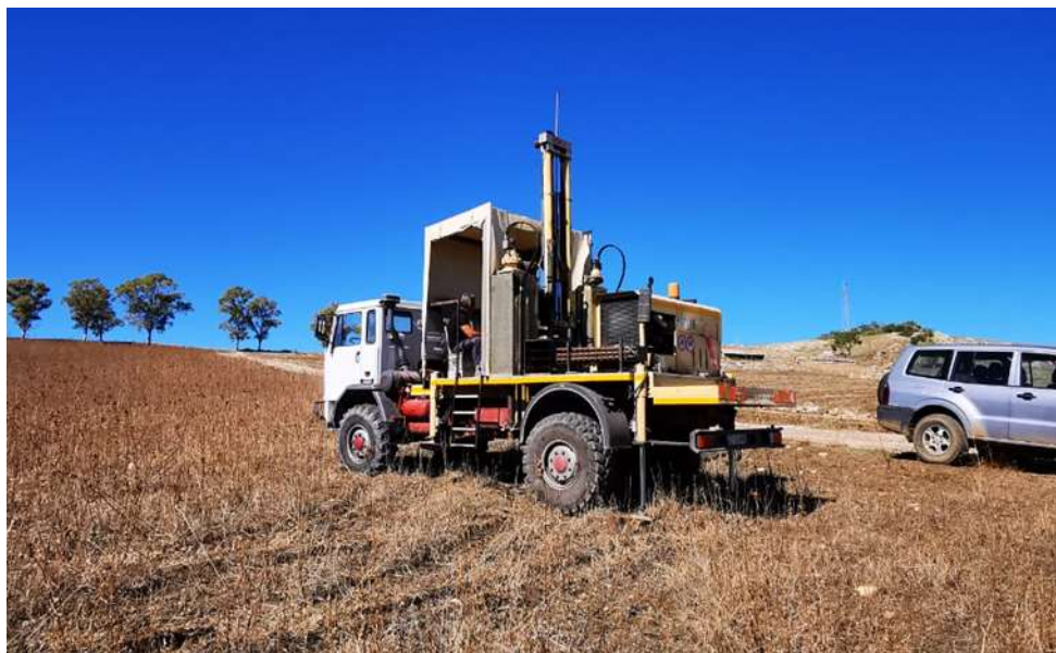
Figura 15 – Penetrometro DPSH per prove SCPT
