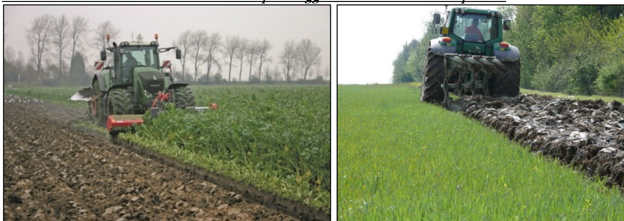
Fig. 6.6: Esempio di pratica del sovescio in pieno campo. Si noti, nell'immagine a sinistra, l'impiego di una trincia frontale montata sulla stessa trattrice per alleggerire il carico sull'aratro portato
