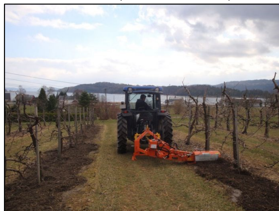
Figura 6.3: Esempio di fresatrice interceppo per le lavorazioni sulla fila (Foto: Rinieri S.r.l.)
