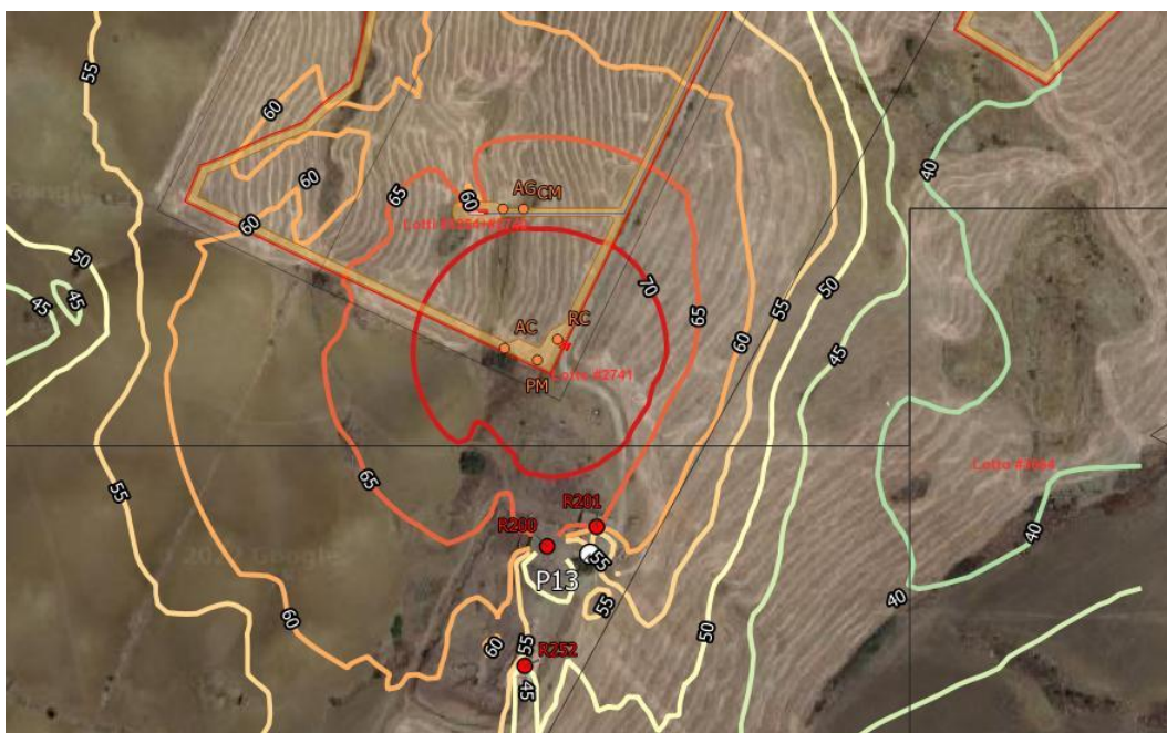
Figura 8 Calcolo delle isofone nella fase di realizzazione della viabilità interna ipotizzando il contemporaneo impiego di autocarro (AC), pala meccanica (PM), rullo compattatore (RC) nelle posizioni più critiche rispetto al recettore R200
