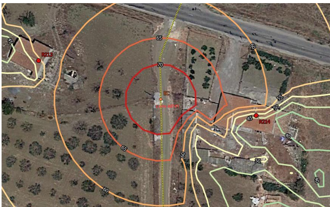
Figura 14 Calcolo delle isofone nella fase di posa del cavidotto AT ipotizzando l'impiego di escavatore bobcat (BC) nelle posizioni più critiche rispetto al recettore R214
