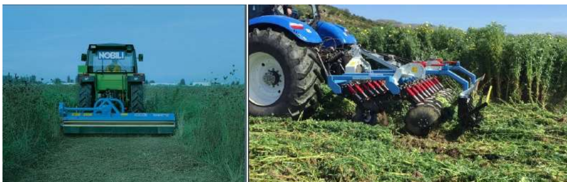
Figura 3: Trinciatura del manto erboso, utilizzando la trincia o direttamente con il frangizolle a dischi
