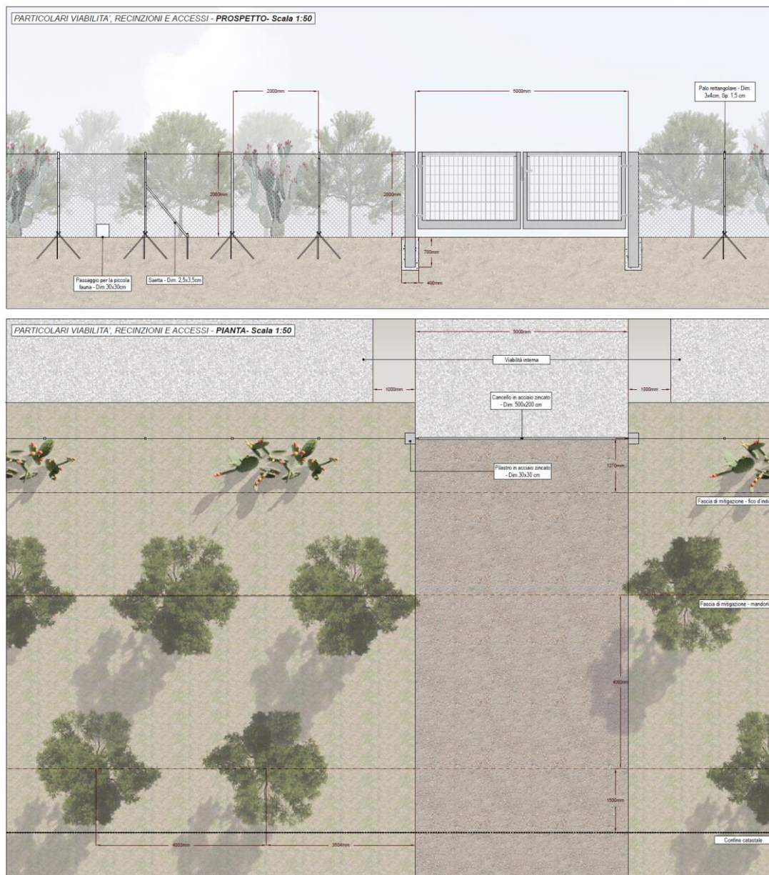
Figura 5: Area di mitigazione di tipo A, in sezione trasversale e in pianta
