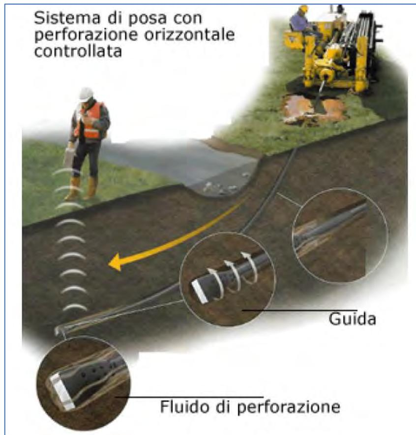
(Fig.34 Trivellazione Orizzontale Teleguidata)
