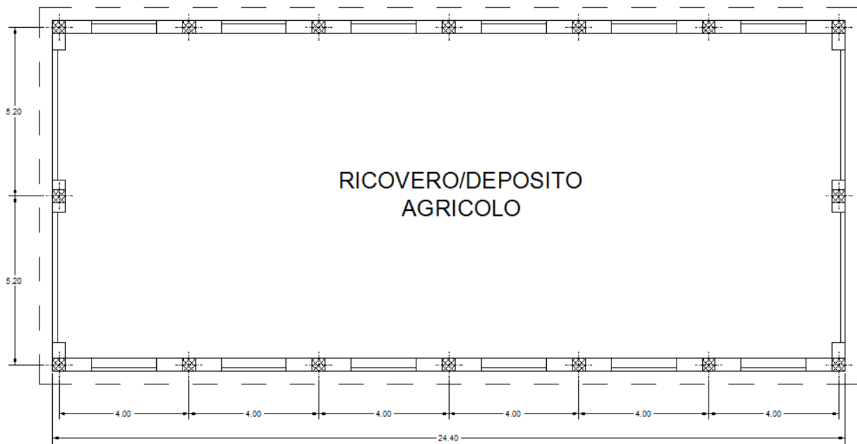
Figura 34: Pianta edificio ricovero mezzi agricoli
