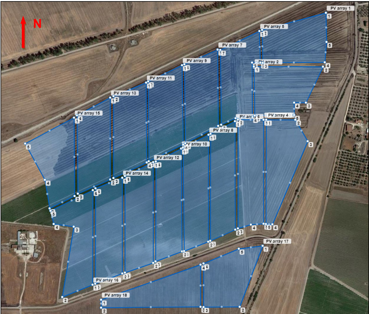
Figura 12 – Immagine satellitare con evidenziato il lotto di terreno interessato dall'installazione dell'impianto agro-fotovoltaico. Per i motivi di cui al Cap. 4 "Strumento di Calcolo", l'intera impronta è stata "scomposta" ed analizzata come più poligoni distinti. Per ognuno di essi i vertici risultano descritti sulla base delle coordinate geografiche così come riportate nell'Allegato B.
