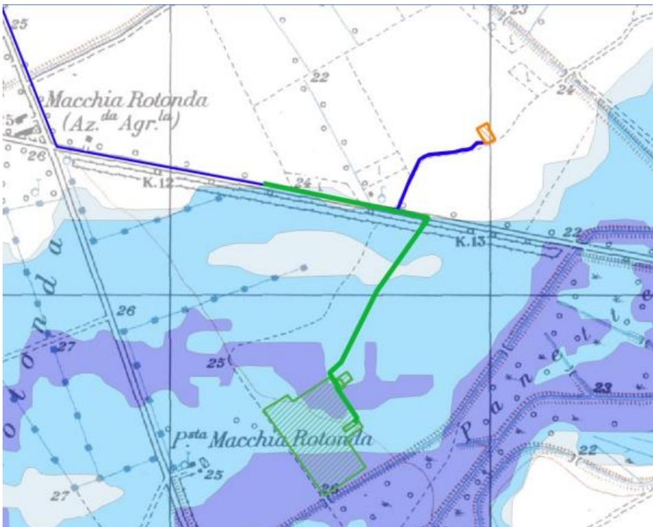
**Figura 1-54: Estratto dell'interferenza tra l'area della stazione terna con le aree perimetrate dal PAI (Fonte: Allegato 08 "Relazione idrologica")**
