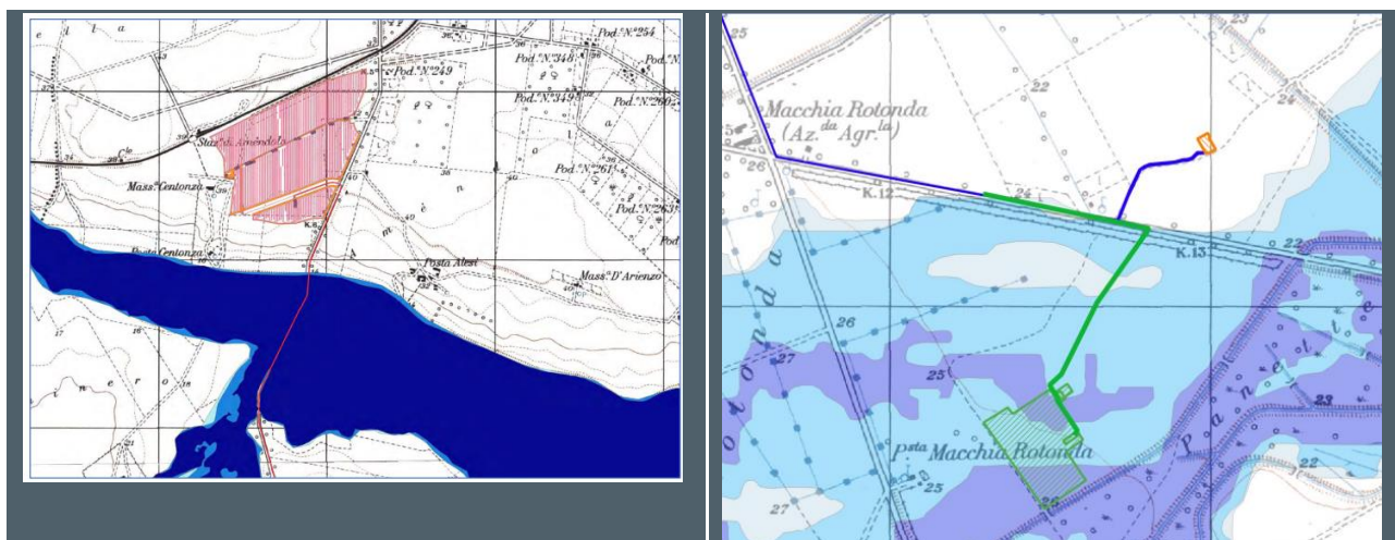
Figura 3-6: estratto dell'interferenza tra l'area dell'impianto agro-fotovoltaico (a sinistra) e dell'impianto di utenza (a destra) con le aree perimetrare dal PAI (Fonte: Allegato 08 "Relazione idrologica")
