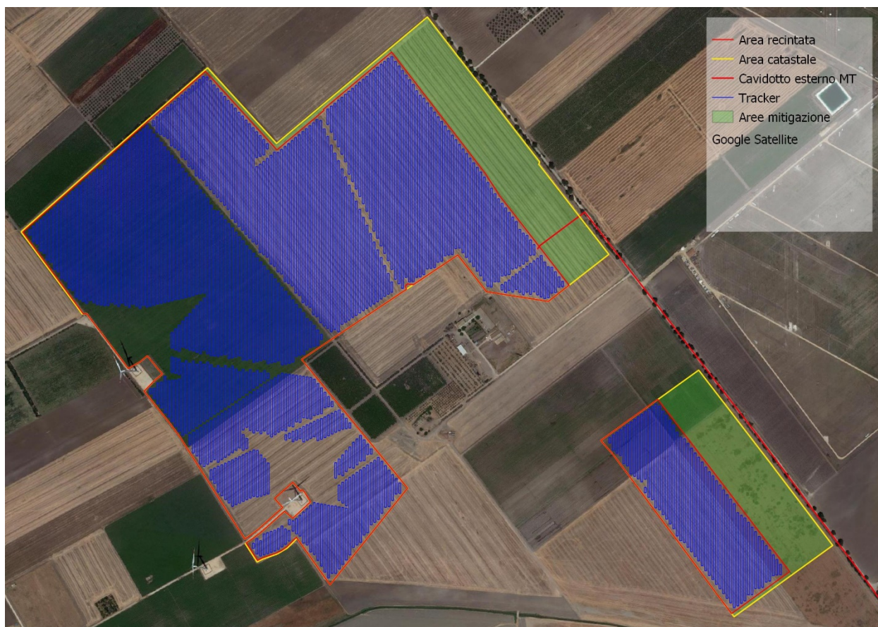
Layout dell'impianto fotovoltaico
