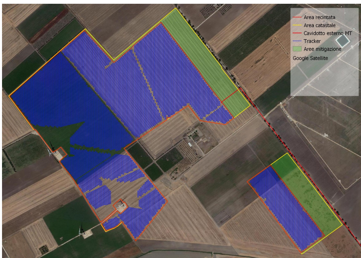
Layout dell'impianto fotovoltaico
