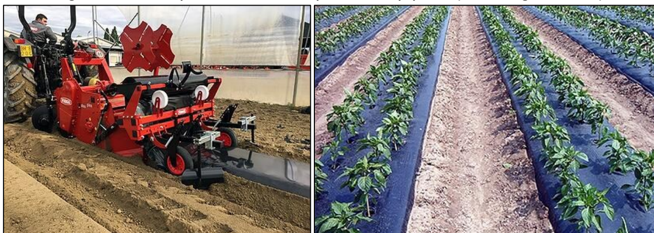
Figura 6.3. Macchina pacciamatrice e coltura pacciamata di peperone (Fonte: Forigo Roteritalia)
