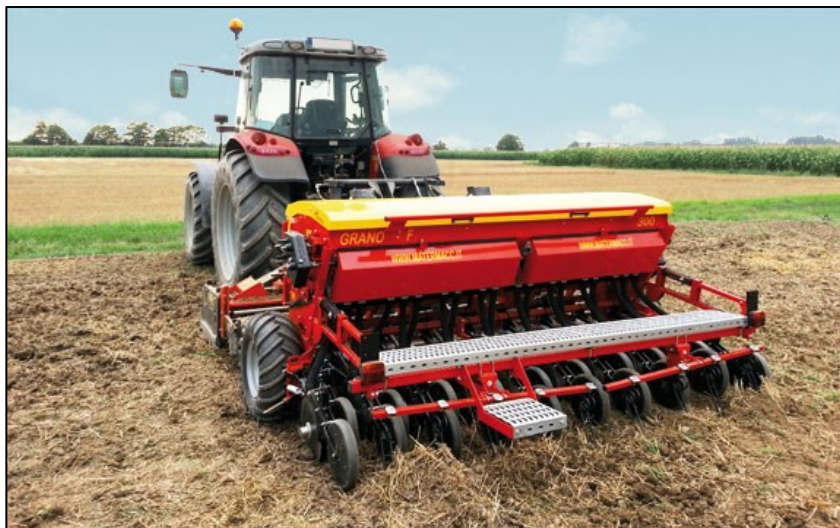
Fig. 6.7: Esempio di seminatrice di precisione per tutte le tipologie di sementi (Foto: MaterMacc S.p.a.)
