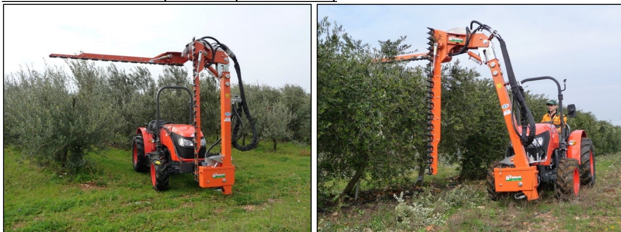
Figura 6.12: Esempio di potatrice meccanica frontale a doppia barra (taglio verticale + topping) utilizzabile su tutti le colture arboree intensive e superintensive (Foto: Rinieri S.r.l.)
