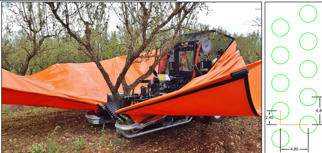
Figura 6.9: Macchina frontale per la raccolta delle mandorle su impianto intensivo e disposizione ideale degli alberi per il corretto impiego della stessa (Foto: Dott. Agr. Vito Vitelli)
