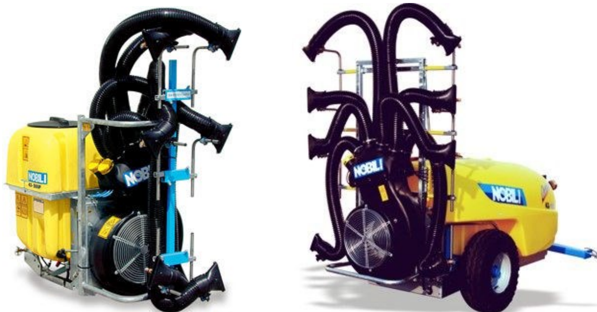
Figura 6.14: Esempi di turboatomizzatore portato e trainato con getti orientabili per trattamenti su uno o entrambi i lati del frutteto (Foto: Nobili S.r.l.)
