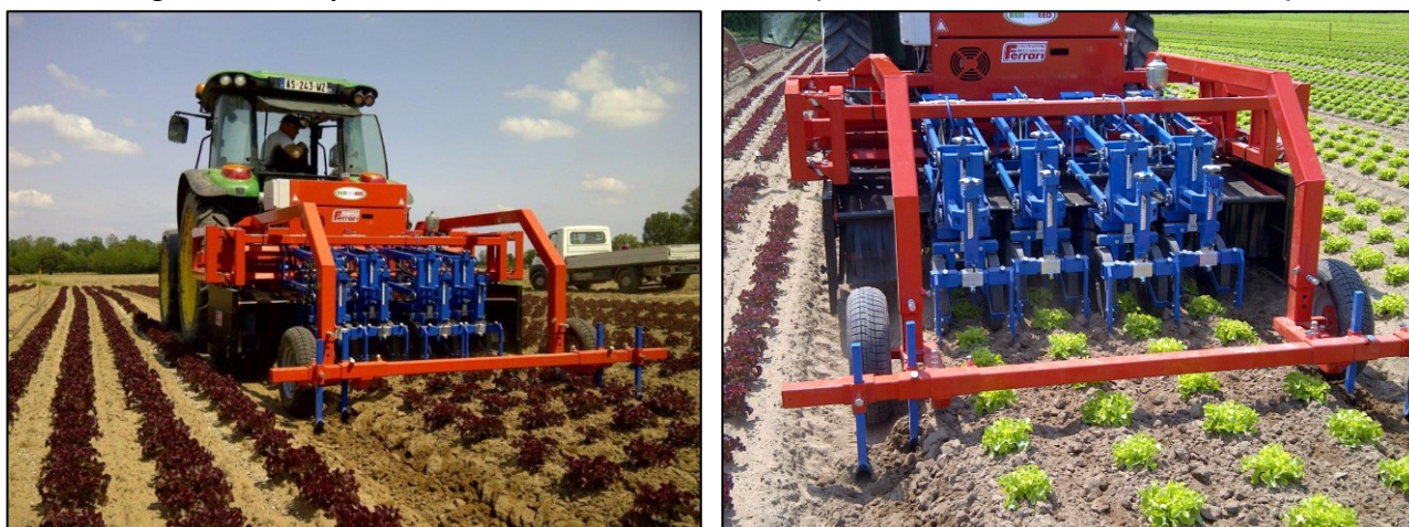
Figura 6.4. Esempio di macchina sarchiatrice su orticole (Fonte: Ferrari Costruzioni Meccaniche)
