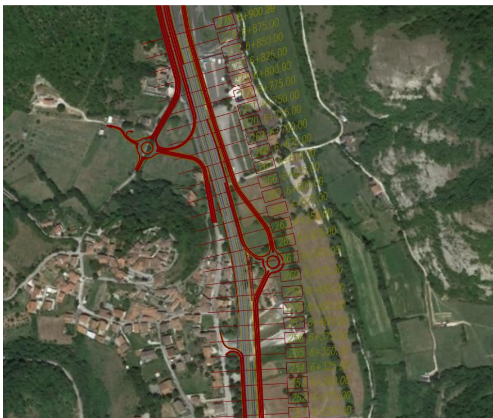
Figura 6 – Tracciato di progetto dal km 70+250 al km 70+900
