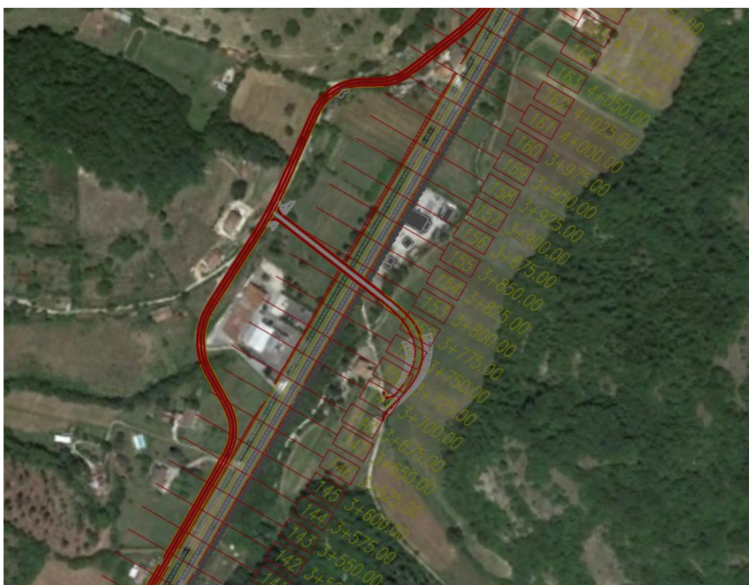
Figura 3 – Tracciato di progetto dal km 67+500 al km 68+050
