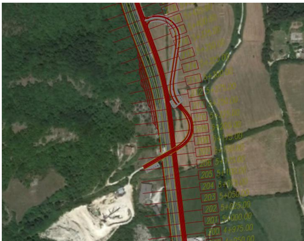
Figura 5 – Tracciato di progetto dal km 68+975 al km 69+457
