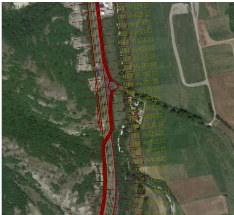
Figura 4 – Tracciato di progetto dal km 68+350 al km 68+925
