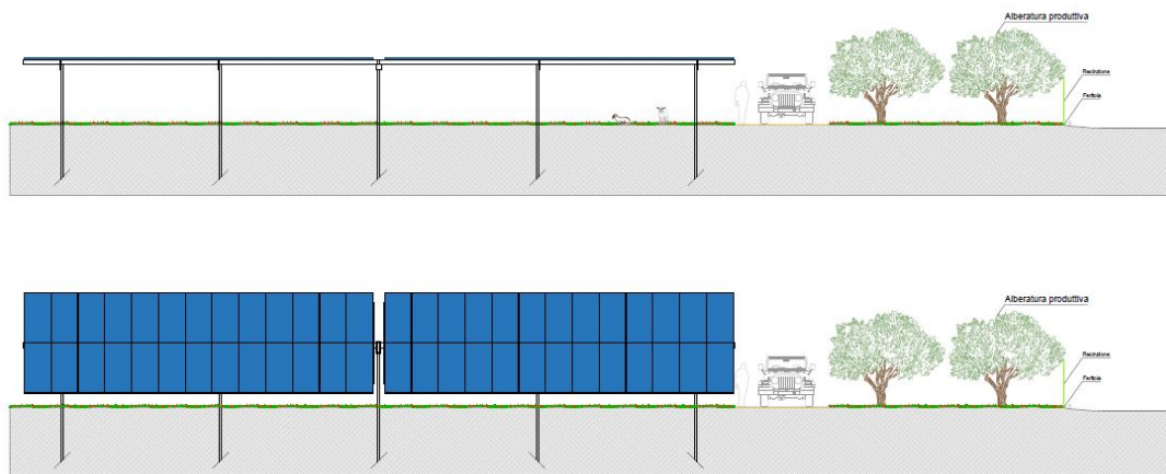
Figura 3- Particolare delle strutture tracker rispetto alle alberature perimetrali
