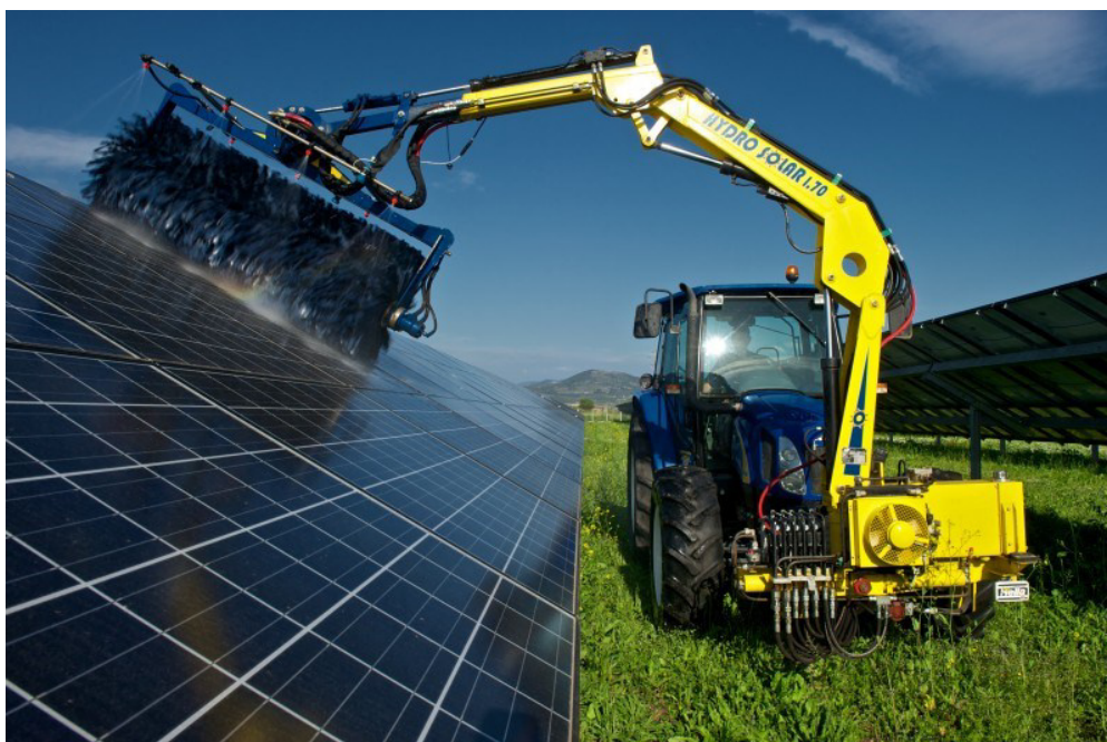
Figura 15 – Esempio di sistema di lavaggio moduli fotovoltaici
