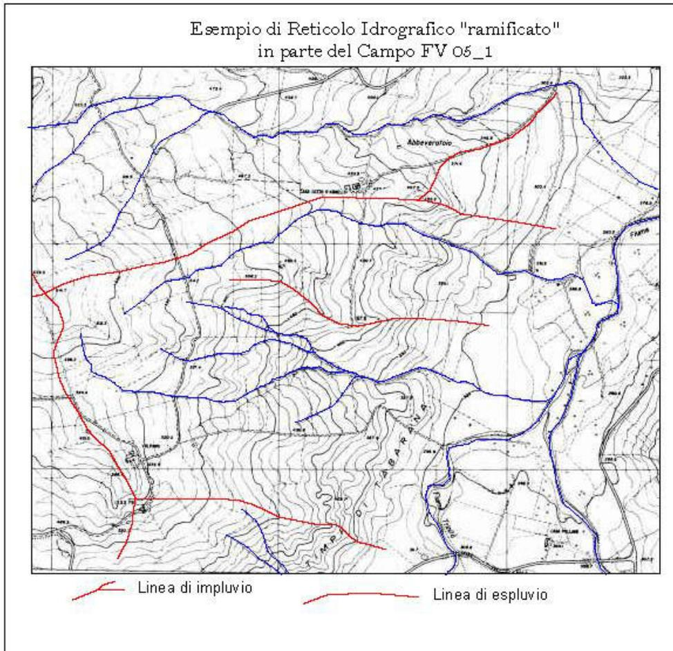
Dall'esempio cartografico sopra riportato, nonostante la presenza di numerosi sottobacini, con relative linee di drenaggio superficiale, nessuna linea di impluvio di significativa rilevanza interferisce con le future strutture (cfr. Tabella sottostante).
