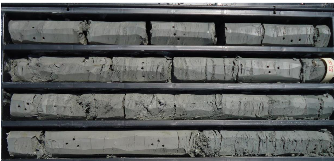
Figura 23: Sondaggio ID01-S01,; argilla sabbiosa fine, grigia
