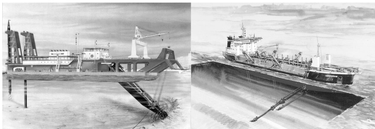
Figura 42 - Draga aspirante refluyente stazionaria (CSD, a sinistra) e autocaricante (TSHD, a destra)
