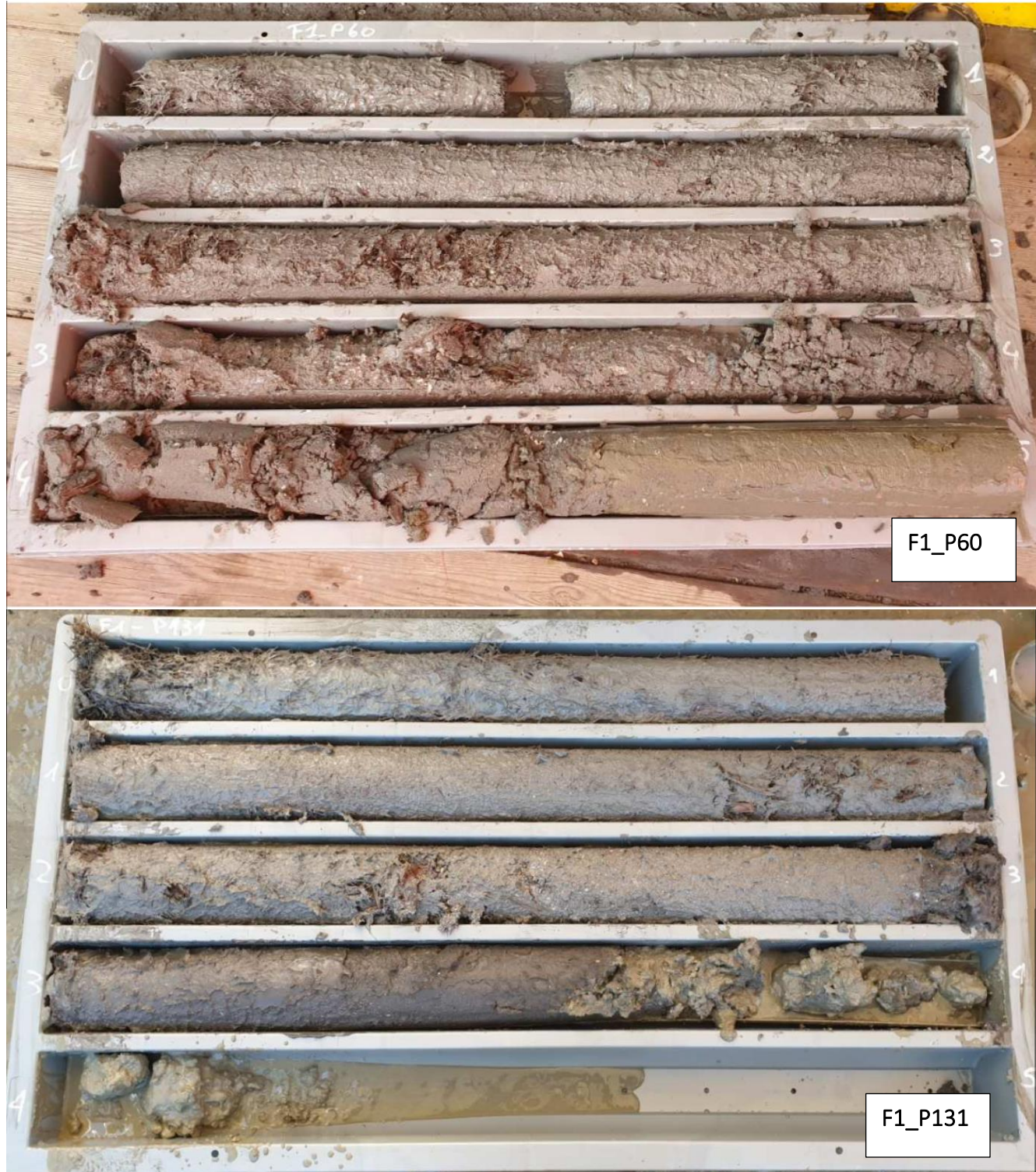
Figura 29: Cassette catalogatrici dei sondaggi F1_P60 e F1_P131: si osservano abbondanti resti algali di Posidonia frammista al sedimento fino a 4 – 5 m di profondità
