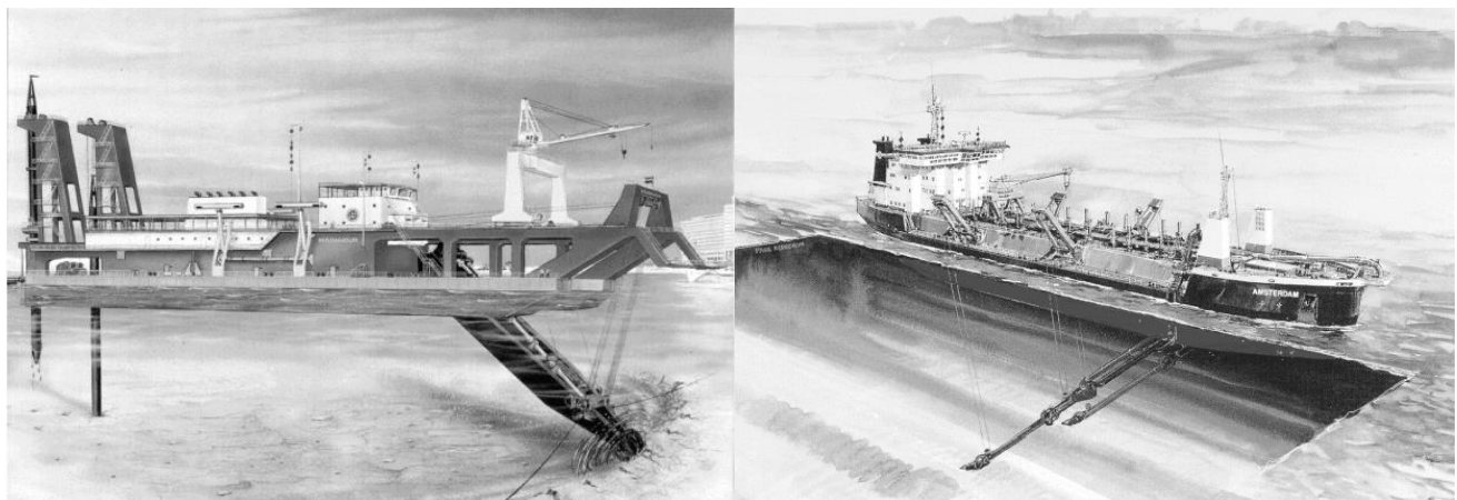
Figura 50 - Draga aspirante refluyente stazionaria (CSD, a sinistra) e autocaricante (TSHD, a destra)
