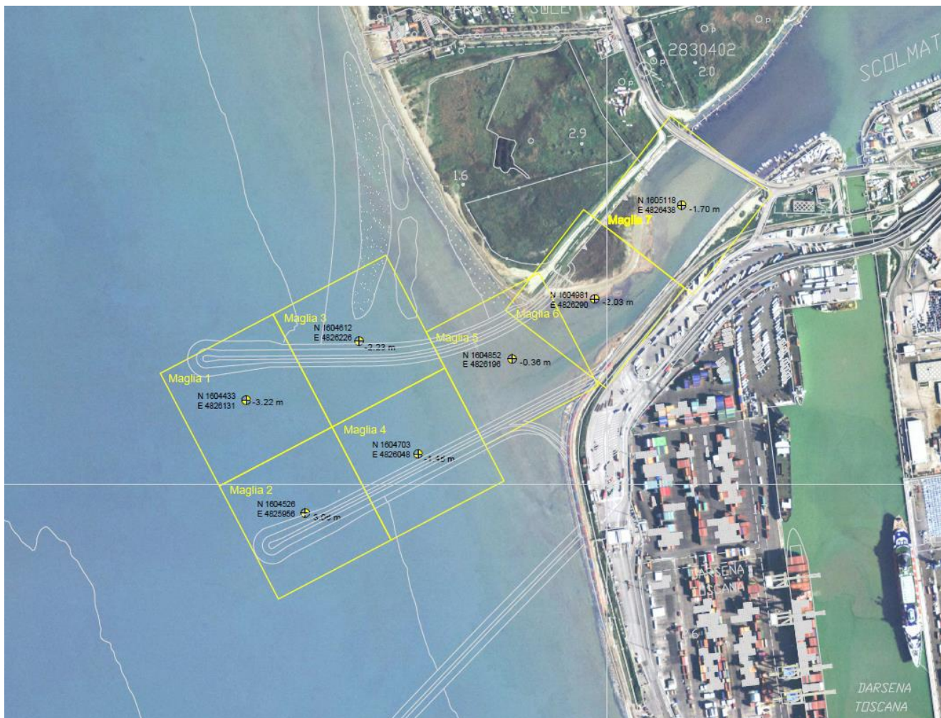
Figura 4: Caratterizzazioni eseguite nell'ambito della realizzazione dell'armatura di foce (2014)
