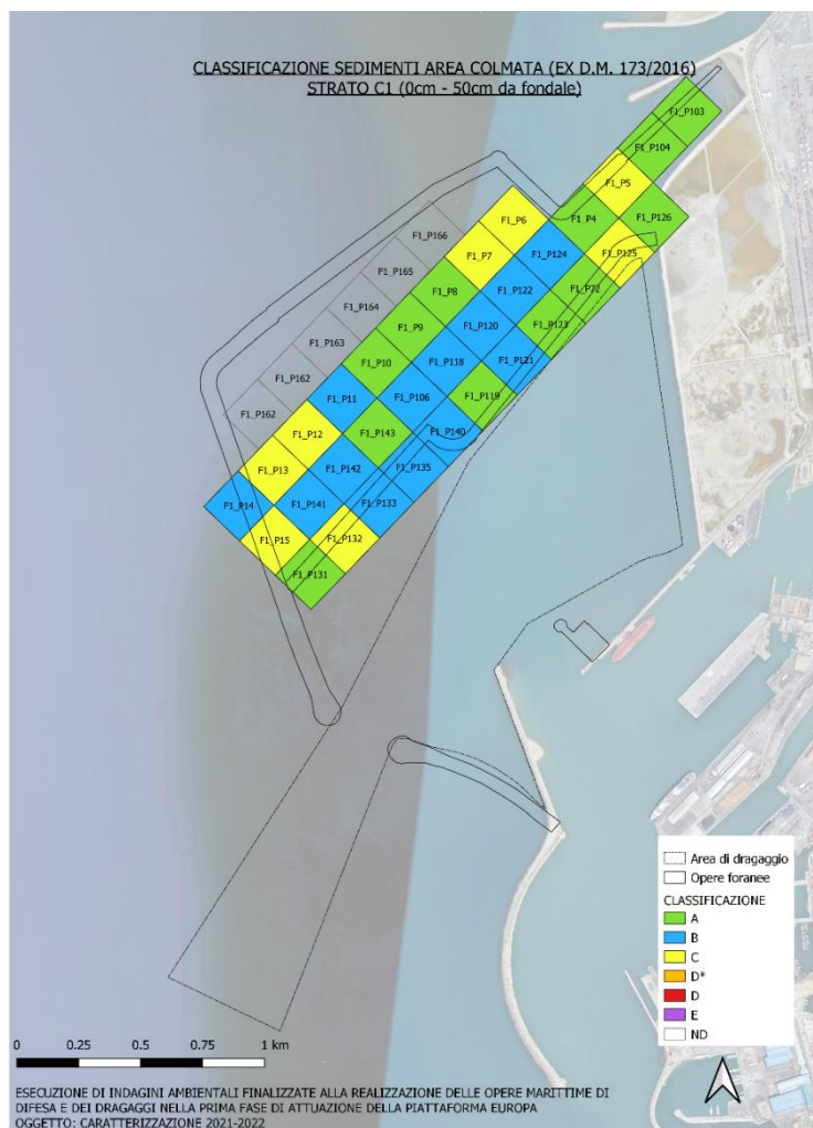
Figura 36: classi di qualità dei campioni di sedimento in funzione delle ipotesi di gestione – livello C1 – area di colmata
