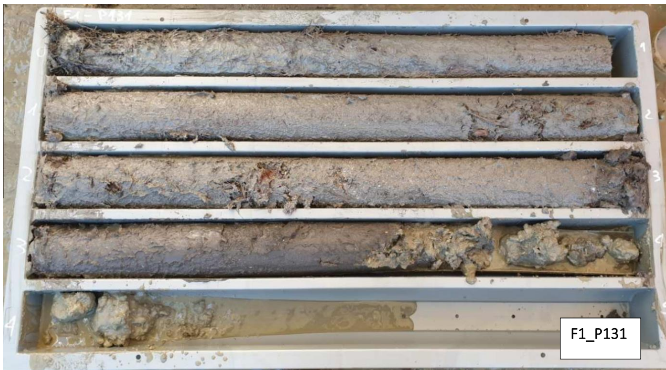
Figura 23: Casette catalogatrici dei sondaggi F1_P60 e F1_P131: si osservano abbondanti resti algali di Posidonia frammista al sedimento fino a 4 – 5 m di profondità
