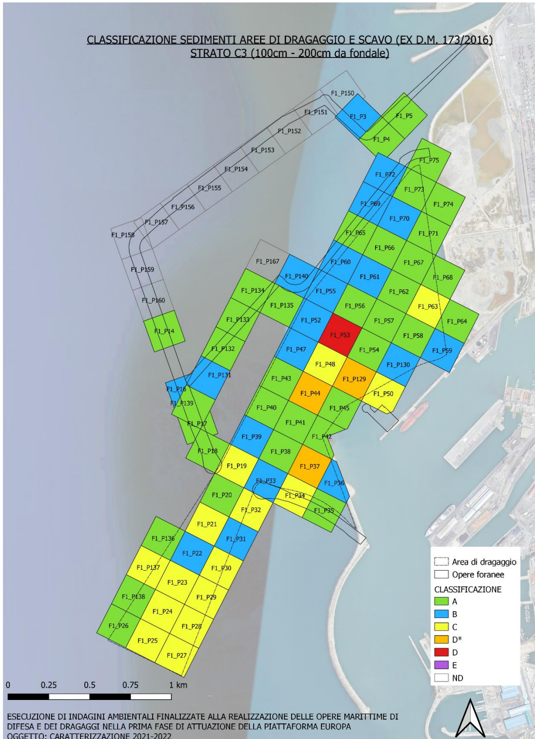
Figura 33: classi di qualità dei campioni di sedimento in funzione delle ipotesi di gestione – livello C3
