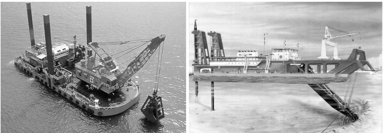
Figura 41 Draghe a benna del tipo a fune (a sinistra) e aspirante refluyente stazionaria (CSD, a destra)
