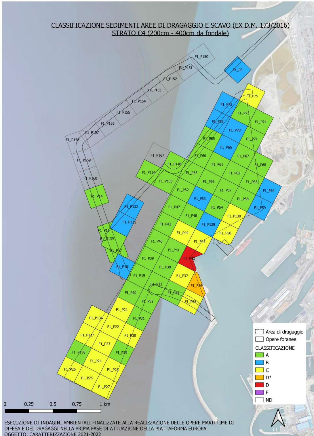
Figura 34: classi di qualità dei campioni di sedimento in funzione delle ipotesi di gestione – livello C4
