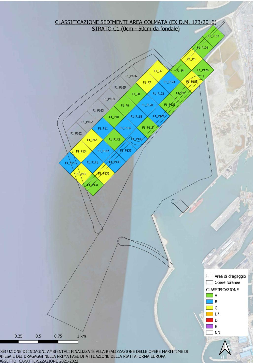
nota 1: Si precisa che il piano di gestione dei sedimenti del progetto prevede esclusivamente lo scarico dei sedimenti dragati in vasca conterminata: una porzione più ampia è finalizzata ad accogliere sedimenti di classe A, B, C e D\*, e una parte sarà impermeabilizzata per accogliere i sedimenti di classe 'D'
