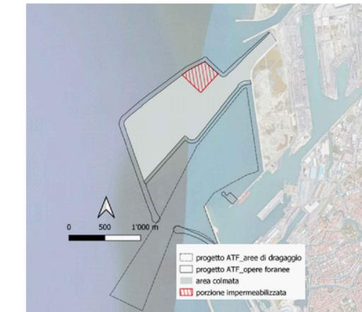
Rappresentazione dell'area di colmata conterminata dove verranno collocati tutti i sedimenti scavati nell'ambito delle opere di progettazione
