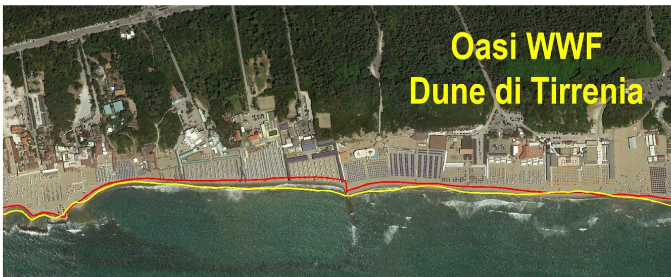
Figura 3.33 - Limite superiore della fascia di battigia rilevato nella zona più critica del litorale di Tirrenia
