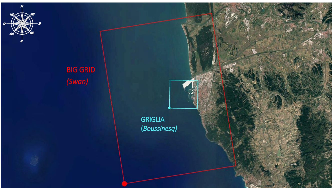
Figura 3.1 - Griglia di calcolo Boussinesq (in azzurro) e griglia di calcolo SWAN (in rosso)
