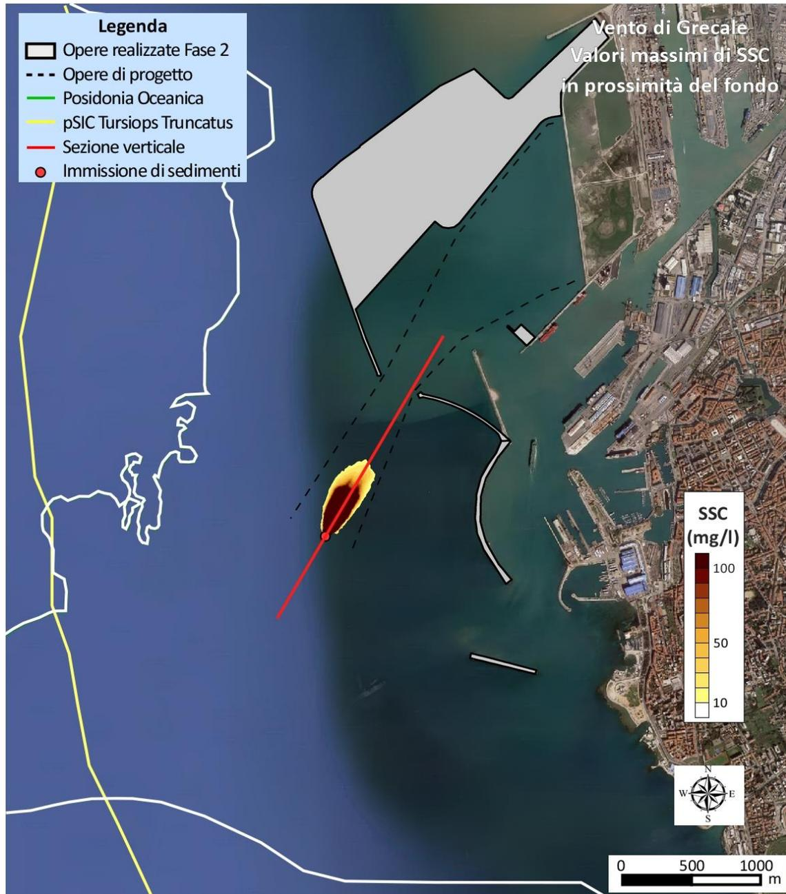
Figura 5.16 - Vento di Grecale, dragaggio del canale di ingresso con draga CSD. Inviluppo della massima concentrazione di sedimenti in sospensione (planimetria).
