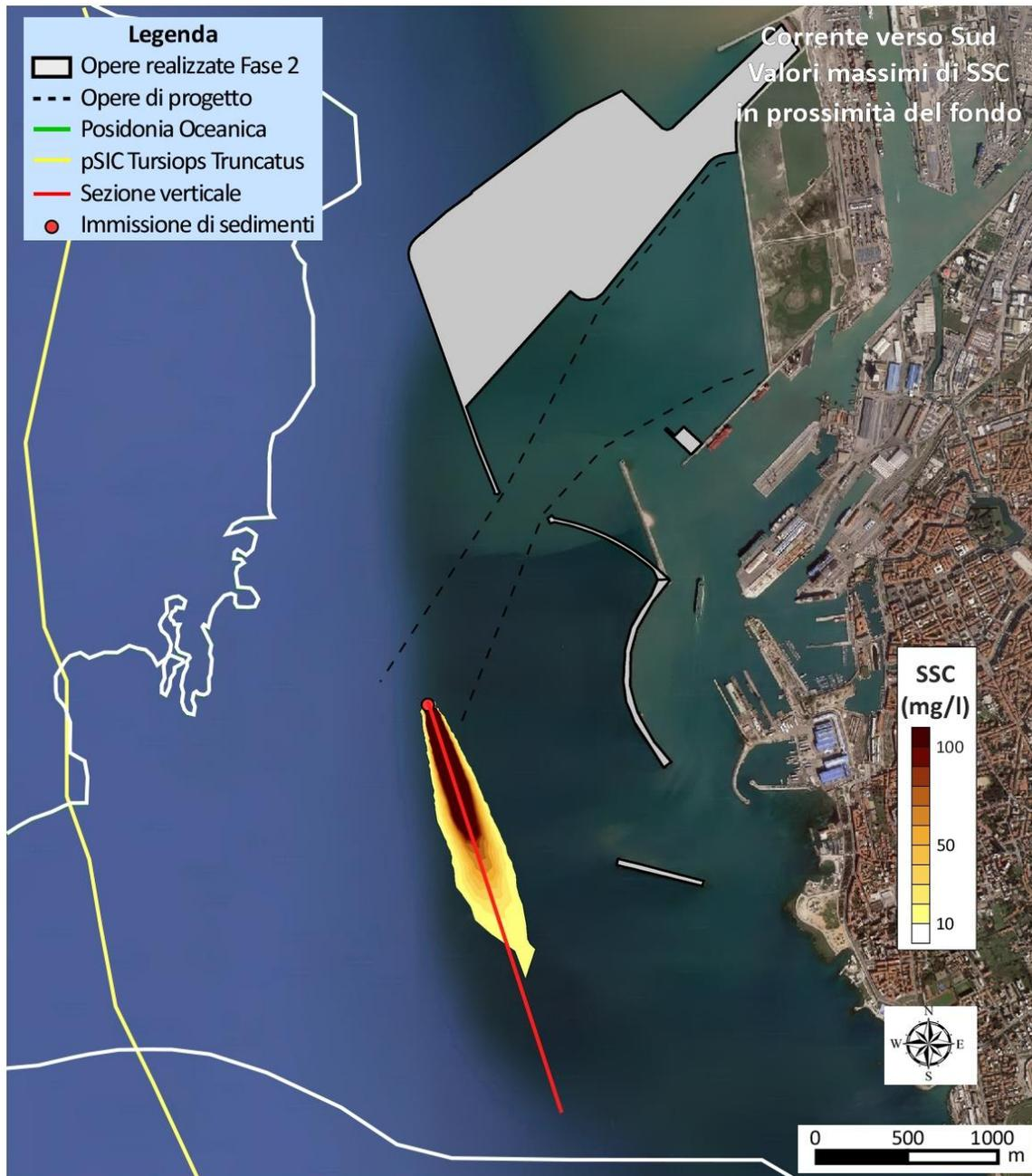
Figura 5.26 - Corrente diretta verso Sud, dragaggio del canale di ingresso con draga CSD. Inviluppo della massima concentrazione di sedimenti in sospensione (planimetria)
