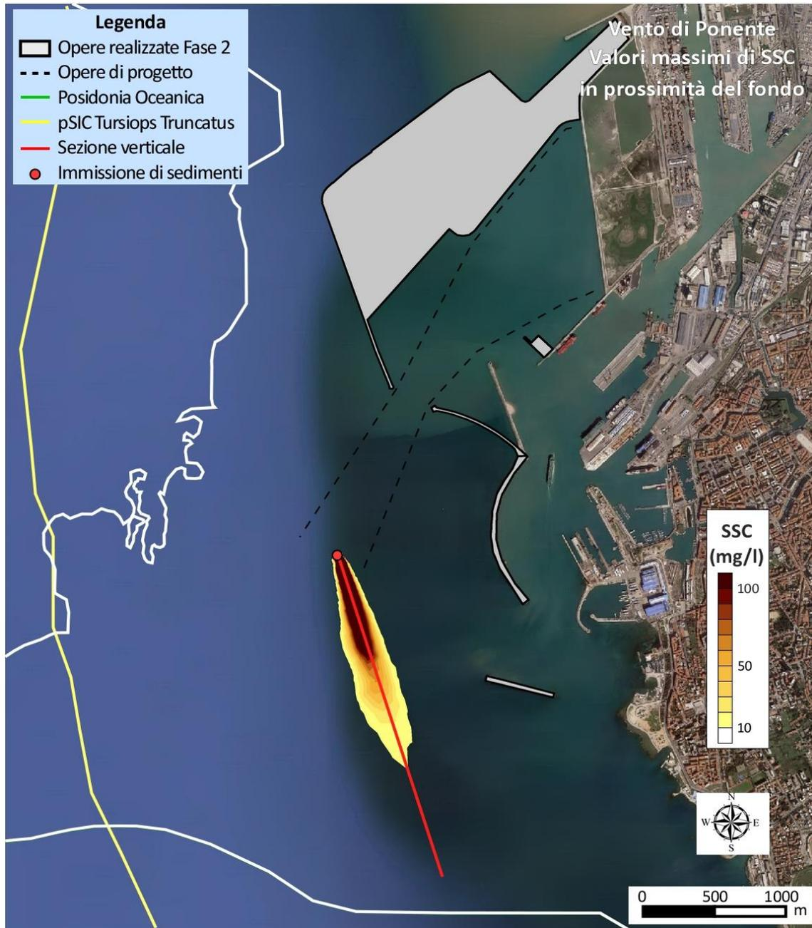
Figura 5.21 - Vento di Ponente, dragaggio del canale di ingresso con draga CSD. Inviluppo della massima concentrazione di sedimenti in sospensione (planimetria)
