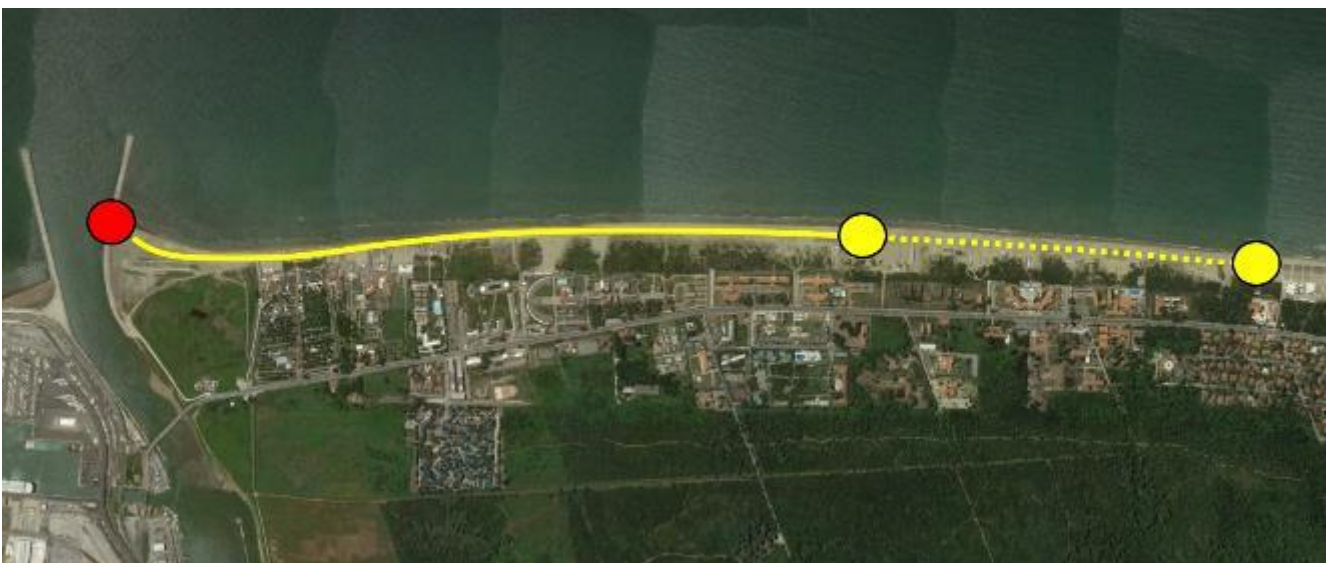
Figura 2.1 - Tracciato del sabbiodotto con punto di collegamento alla draga (rosso) e punti di scarico (giallo); la linea gialla continua indica la tubazione fissa, mentre quella tratteggiata la tubazione mobile, alimentata dall'eventuale booster
