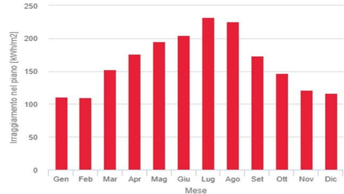
Il calcolo del rendimento è stato integrato con il software PVGIS-SARAH i cui dati di insolazione e di rendimento sono sintetizzati nella tabella in basso e graficamente nei grafici sulla destra. In alto la radiazione media mensile, in basso il rendimento di un impianto ad inseguimento standard.
