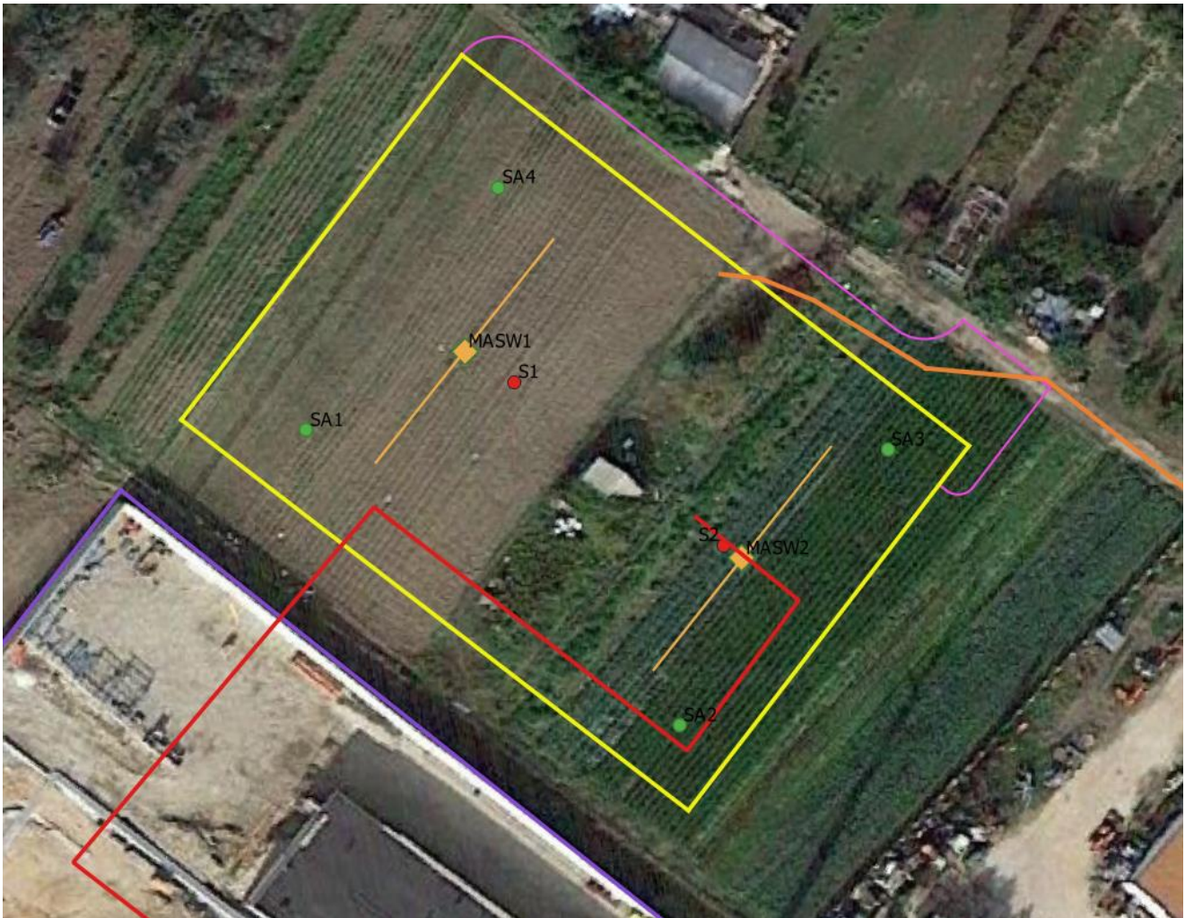
Figura 22: Ubicazione dei sondaggi geotecnici e ambientali
