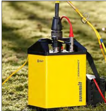
Fig.2 – Sismografo 24 canali modello Compact.
