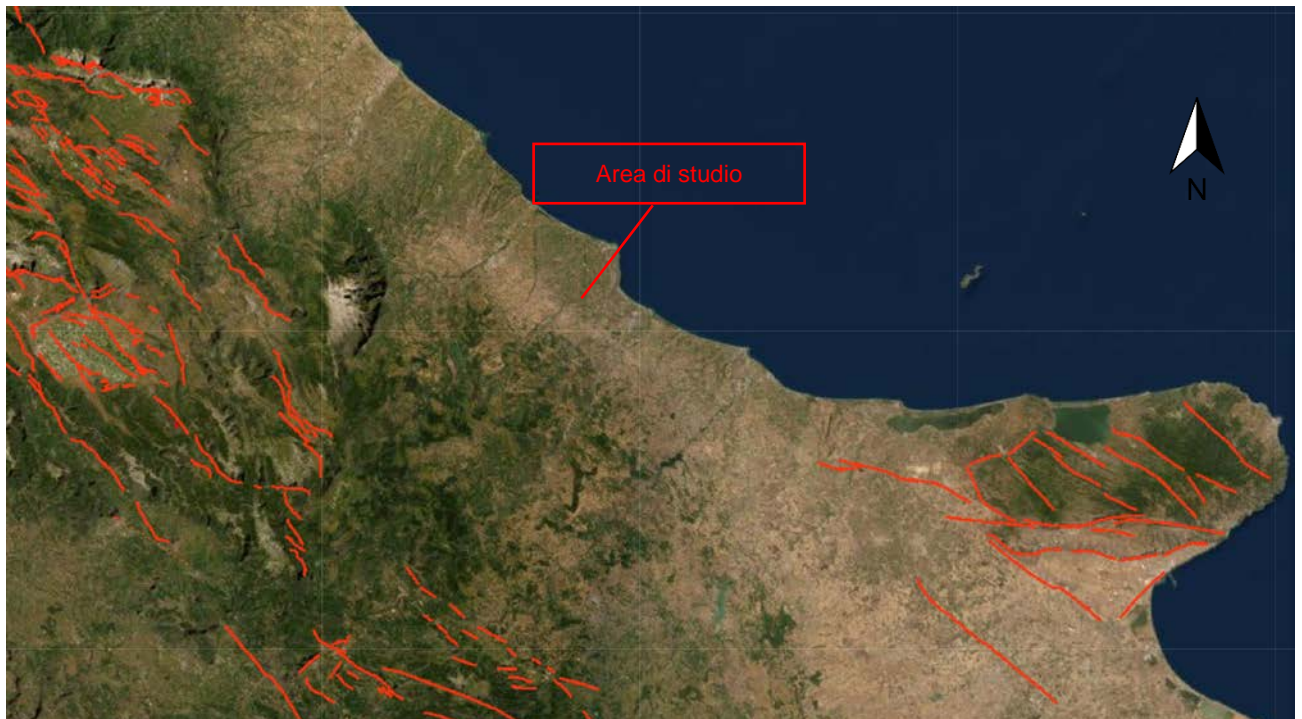
Figura 8-2: Progetto ITHACA Faglie capaci. I tratti rossi sono le faglie capaci e attive.
