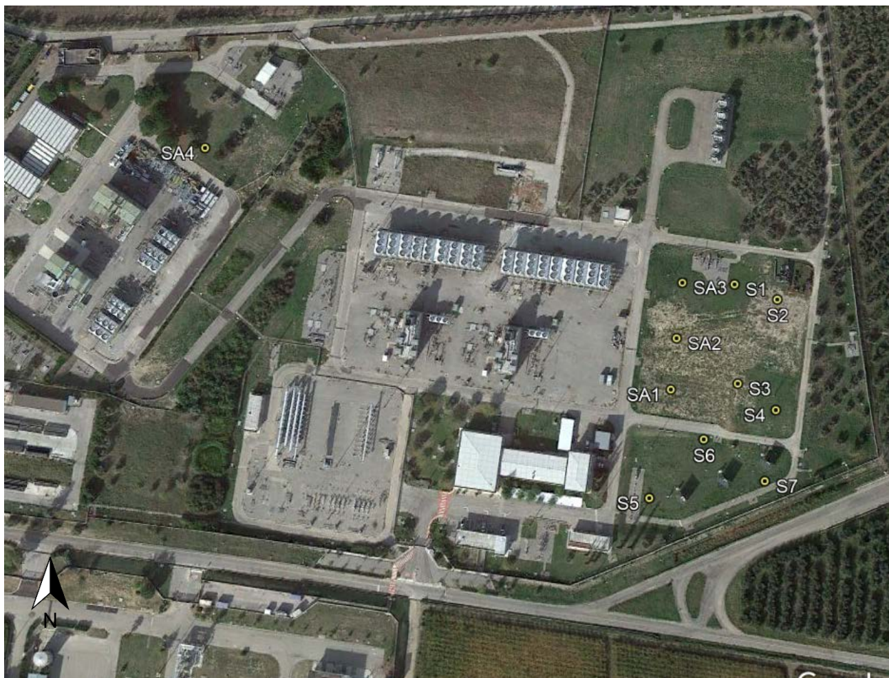
Figura 6-1: ubicazione delle indagini geognostiche ed ambientali. S: sondaggi geognostici; SA: sondaggi ambientali.
