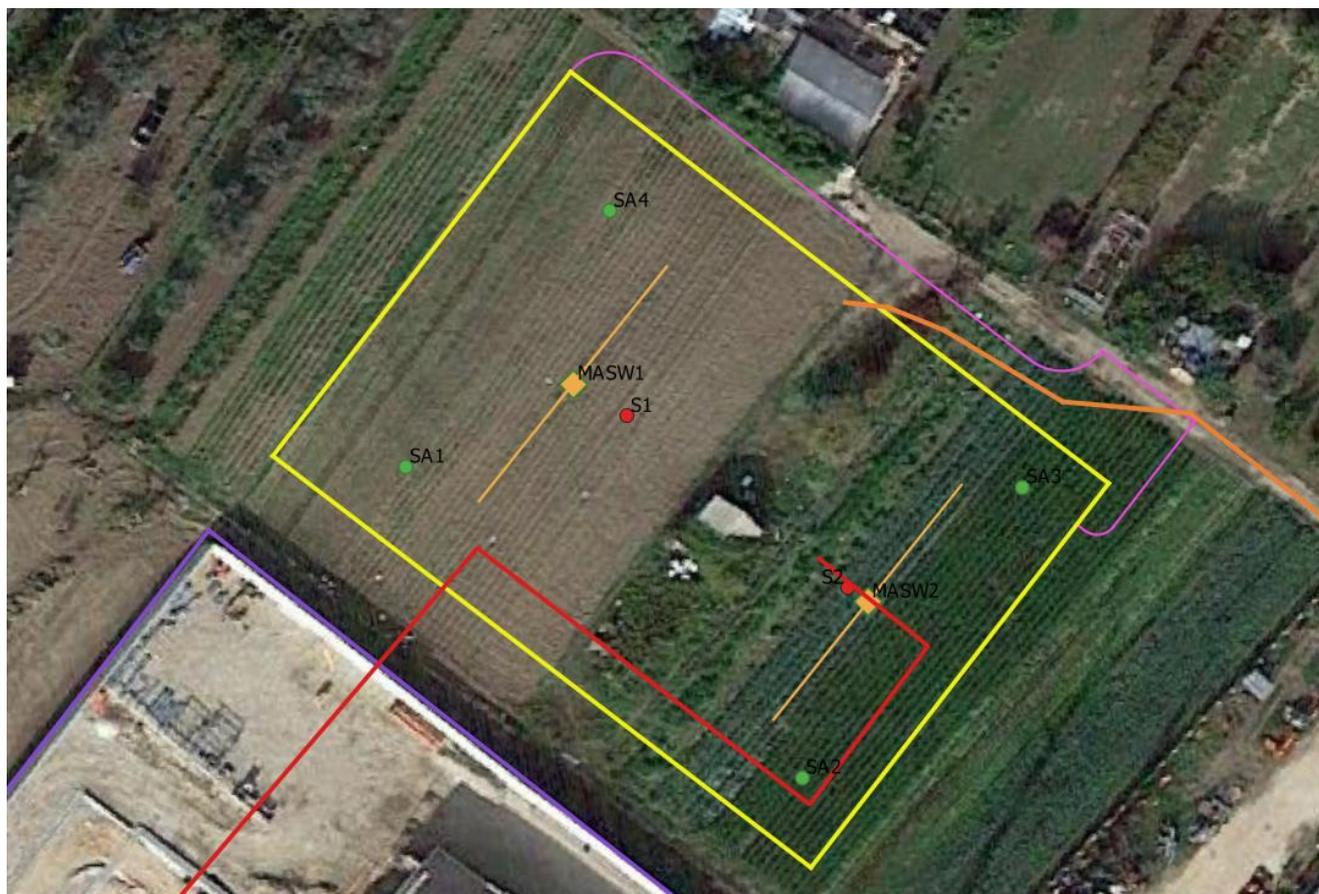
**Figura 45: Ubicazione dei sondaggi geotecnici e ambientali**
