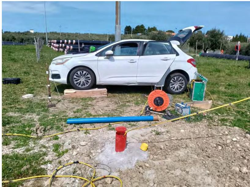
Fig.4 – Postazione prova DH S4.
