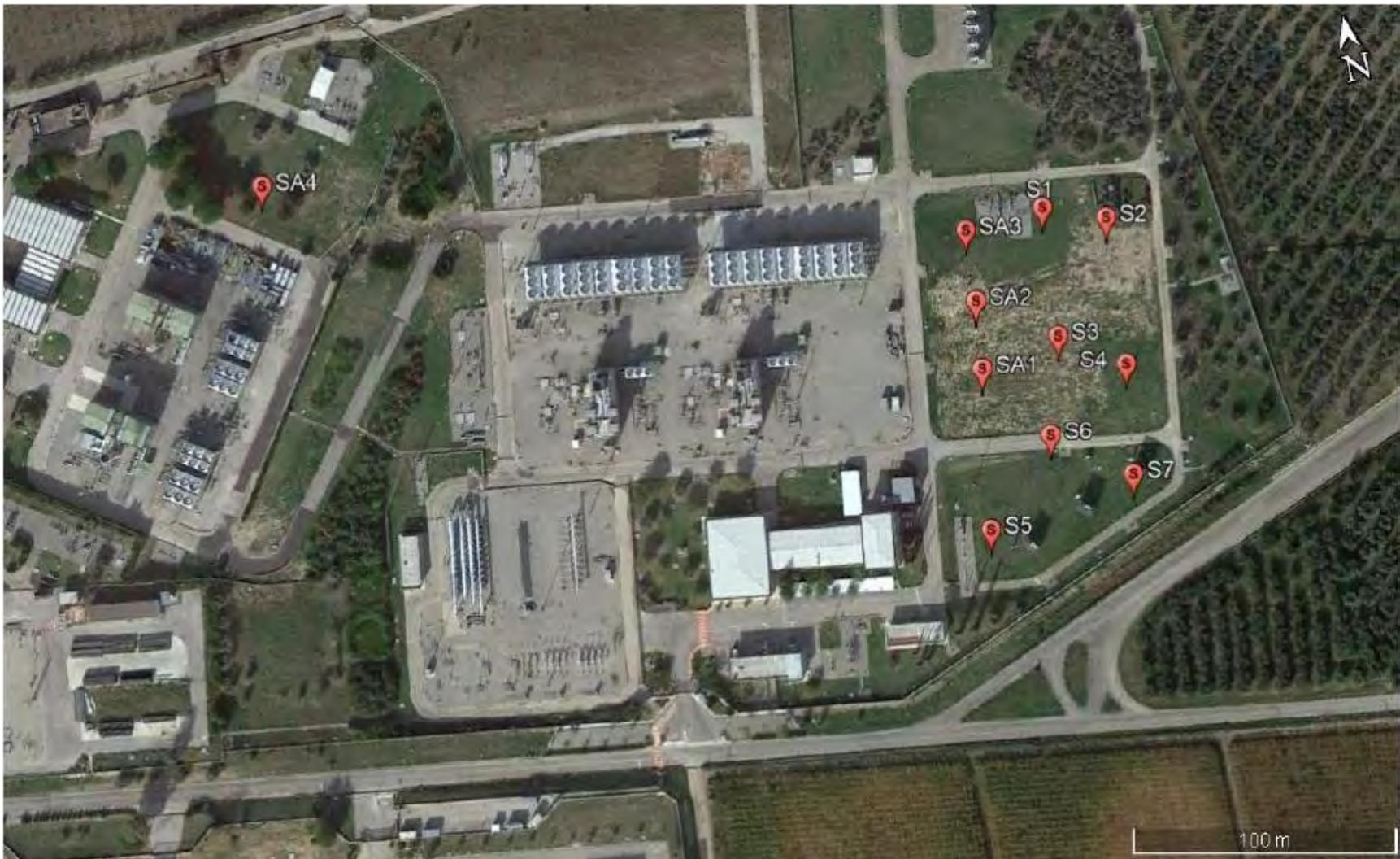
Figura 6-1 ubicazione indagini di caratterizzazione in corrispondenza dell'area della centrale STOGIT oggetto degli interventi in progetto (linea rossa: perimetro centrale; punti con sigla S: Sondaggi geognostici; punti con sigla SA: Sondaggi Ambientali)
