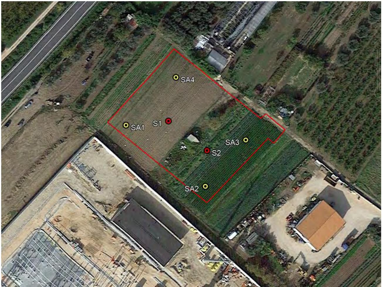
Figura 6-2 ubicazione indagini di caratterizzazione in corrispondenza dell'area della futura sottostazione elettrica (linea rossa: perimetro indicativo della sottostazione; punti rossi: sono i sondaggi geognostici; punti gialli: sondaggi ambientali)
