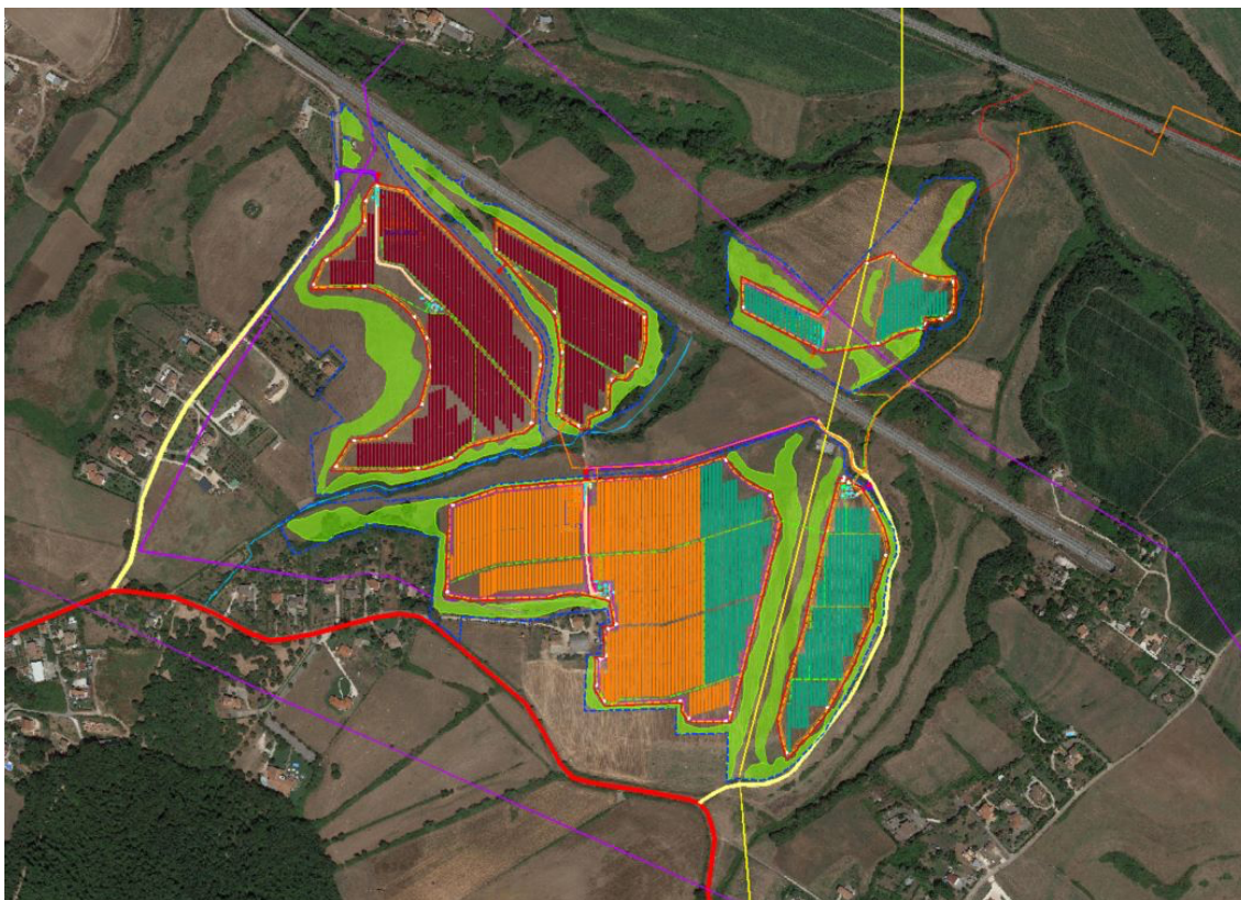
Figura 1. Layout dell'impianto fotovoltaico di Gavignano CAMPI T1 (rosso), T2 (verde scuro), T3 (arancio). Le fasce verdi perimetrali rappresentano le mitigazioni ambientali
