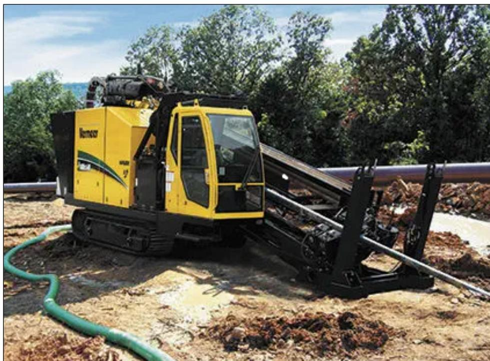
**Figura 2.** Esempio di macchina perforatrice per T.O.C.
